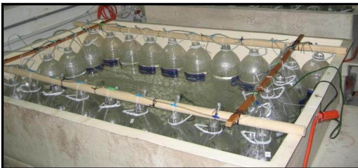
**Figura 1.-** Sistema experimental utilizado en los bioensayos de liberación de nutrientes.
