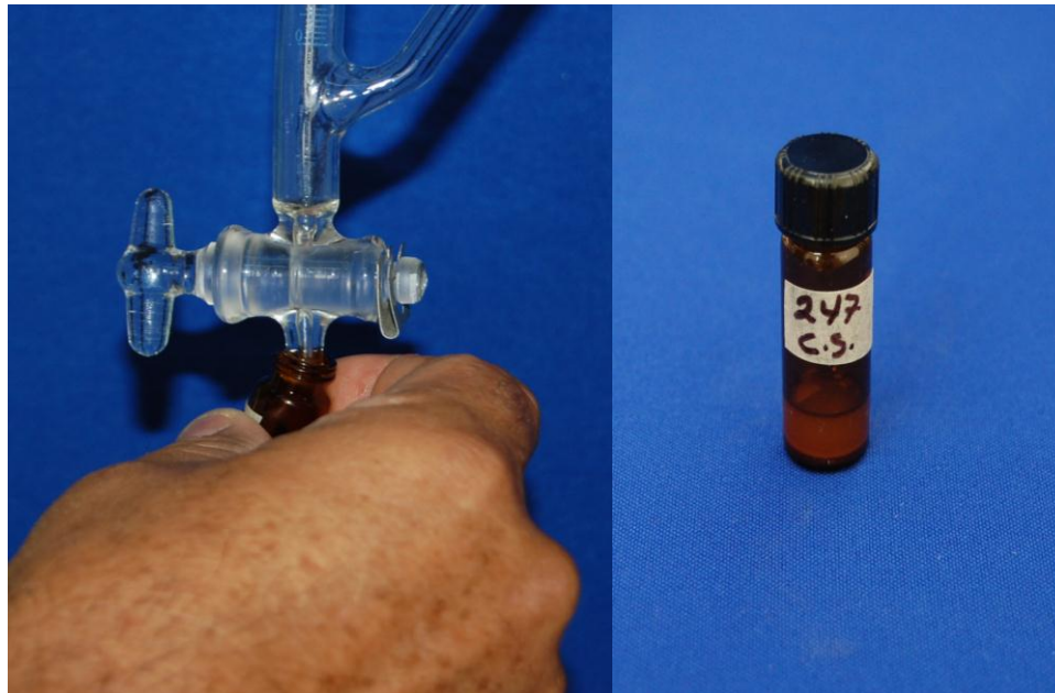
Figura 11. Recuperación de aceites esenciales libre de agua floral, etiquetado y cuantificación gravimétrica de la muestra.
