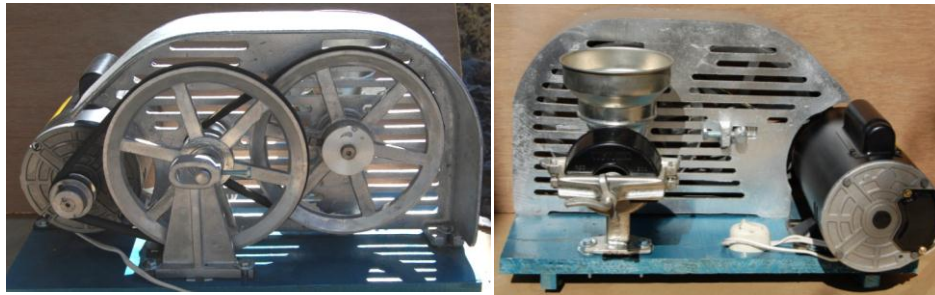
Figura 7. Molino tipo copa acondicionado con doble polea activado por un motor eléctrico de \frac{1}{2} HP, 1740 RPM.
