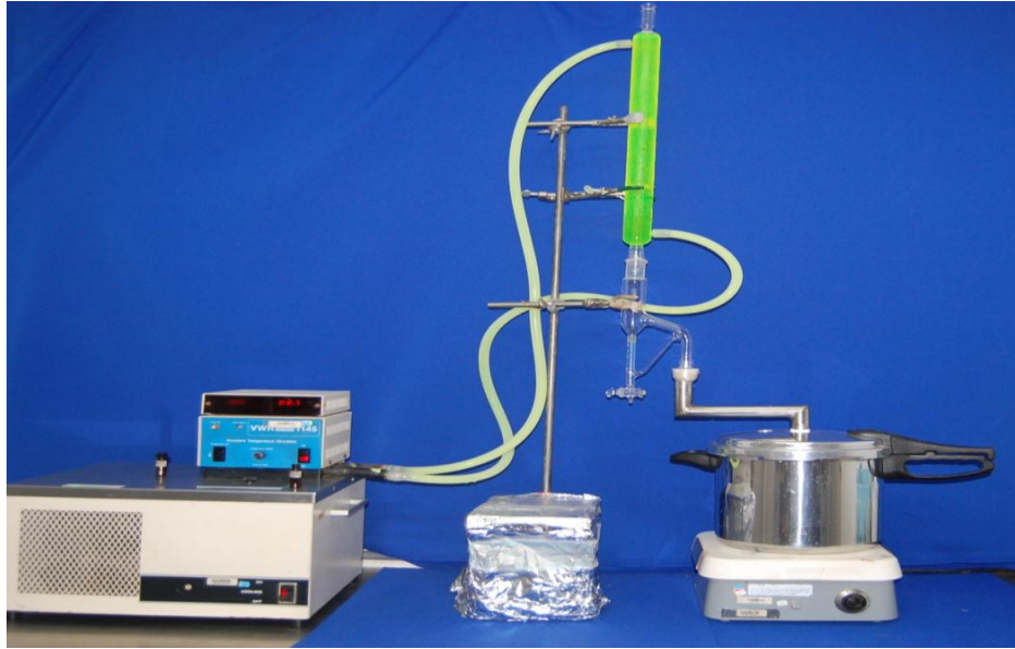
Figura 9. Equipo con modificación en el hidroddestilador, utilizado en análisis de aceites esenciales a nivel laboratorio en plantas de albahaca.
