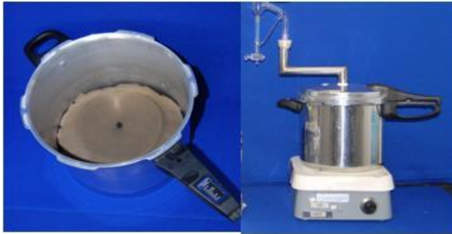
Figura 8. Hidrodestilador acondicionado con una parrilla-malla que sostiene el material pulverizado y una conexión hermetica entre la tapa y el condensador.
