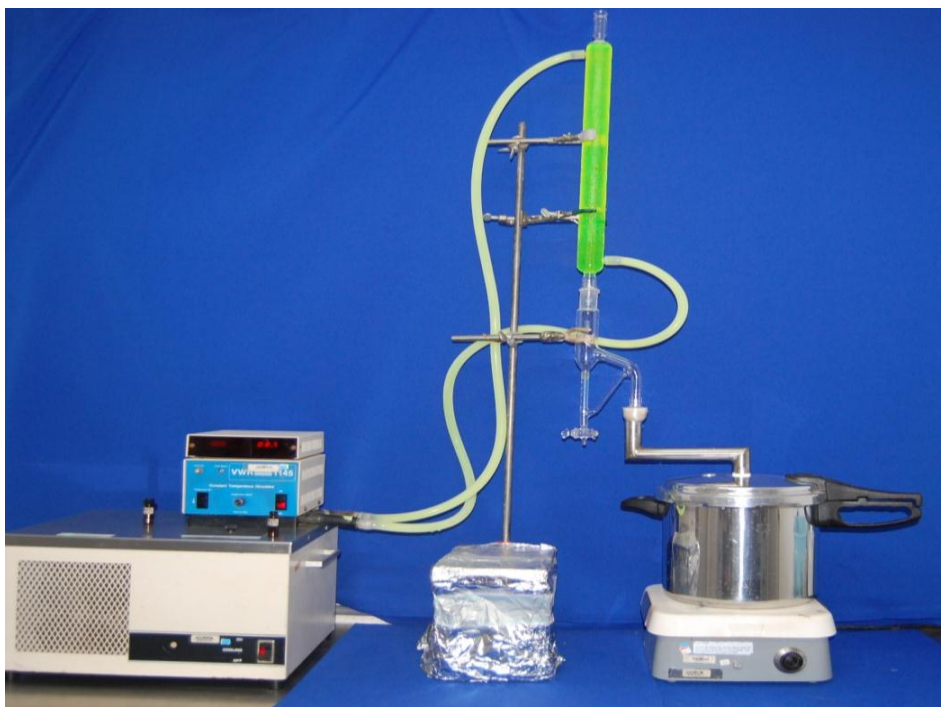
Figura 2. Equipo para destilación modificado con trampa Clevenger.
