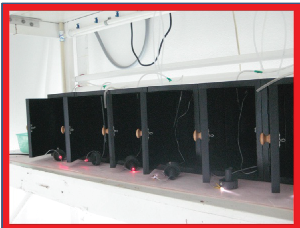
Fig. 12 Detalle fotográfico del sistema “A” de producción de microalgas con luz monocromática donde se muestra los LEDs rojos y blancos encendidos.
