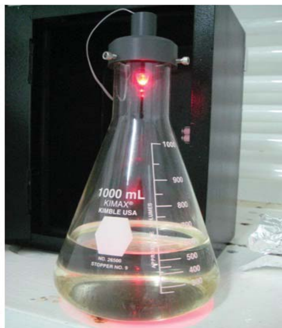
Fig. 11 Elementos del sistema “A” de producción de microalgas con luz monocromática. Diagrama de (A) tapón especialmente diseñado para sostener LEDs para matraces Erlenmeyer de 1-Litro y (B) detalle fotográfico de un matraz de 1-L con el tapón y LED rojo encendido donde se aprecia el ángulo estrecho de luz la cual genera el LED. El tapón de plástico para sujetar LEDs fue diseñado y elaborado en el taller de maquinados del CIBNOR.
