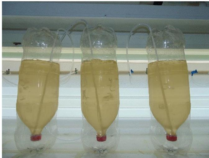
Figura 6. Sistema de cultivo semi-continuo empleado en los experimentos de aplicación de estrés a *T. dictyotum* durante la segunda etapa de cultivo.
