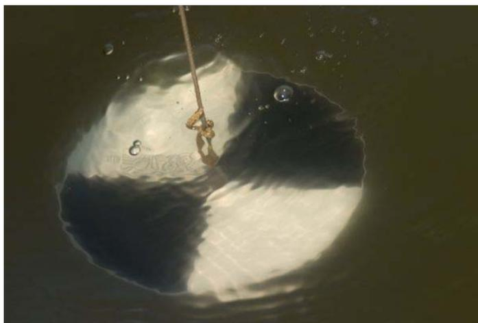
**Figura 9.** Disco secchi para le medición de la turbidez del agua.
