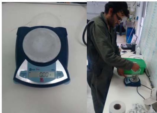
**Figura 13.** Balanza portátil Scout® Pro modelo SP602, OHAUS 600 g
