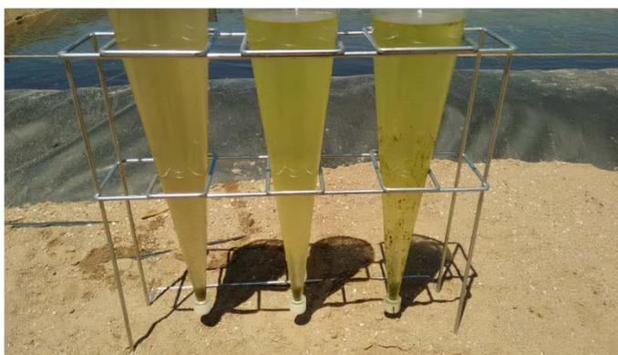
**Figura 10.** Conos Imhoff para la determinación de sólidos sedimentables.
