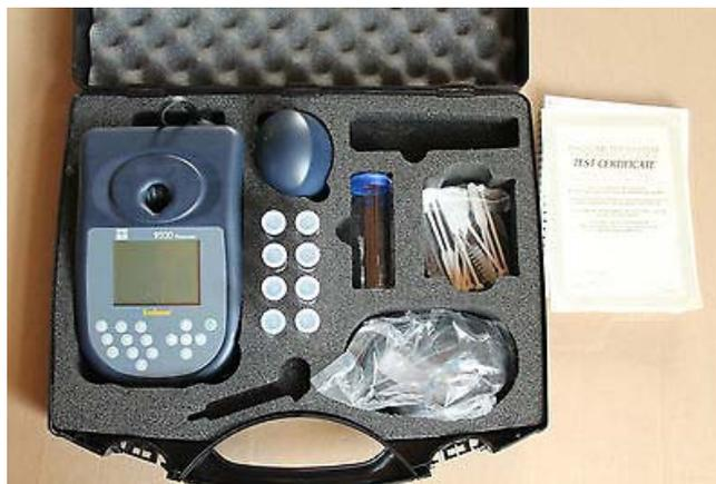
**Figura 11.** Fotómetro YSI 9500 para análisis de nutrientes en el agua.
