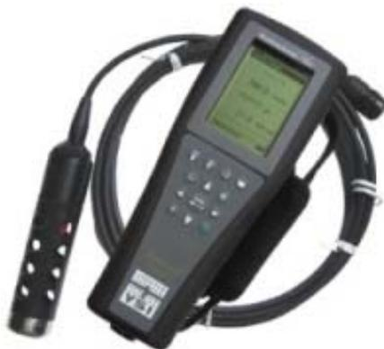
**Figura 8.** Sonda multiparámetros YSI Professional Plus®.
