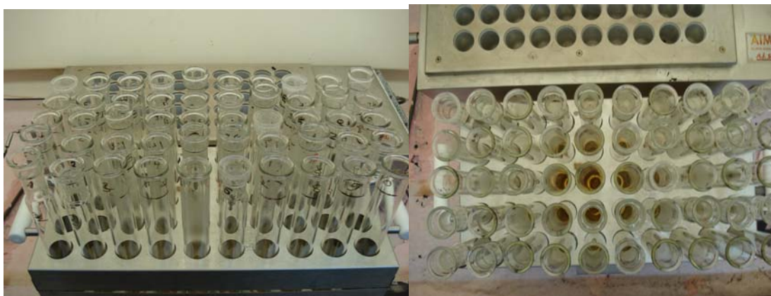
Figura 10. Los tubos Tecator MR de 100 mL con el contenido de óxido crómico (Cr 2 O 3 ) en las muestras (método de Furukawa y Tsukahara, 1966).
