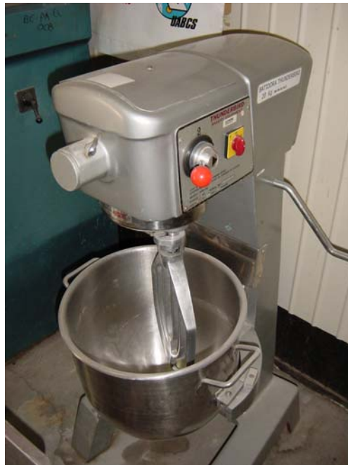
Figura 3. Batidora industrial utilizada para la mezcla de los ingredientes
