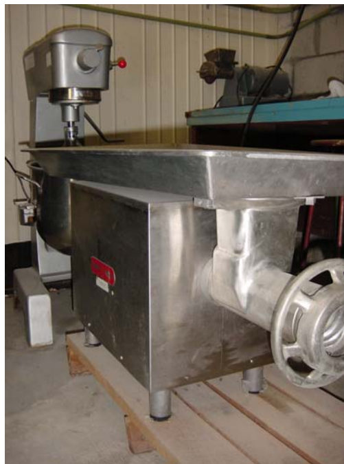
Figura 4. Molino de carne utilizado para la elaboración del alimento peletizado.
