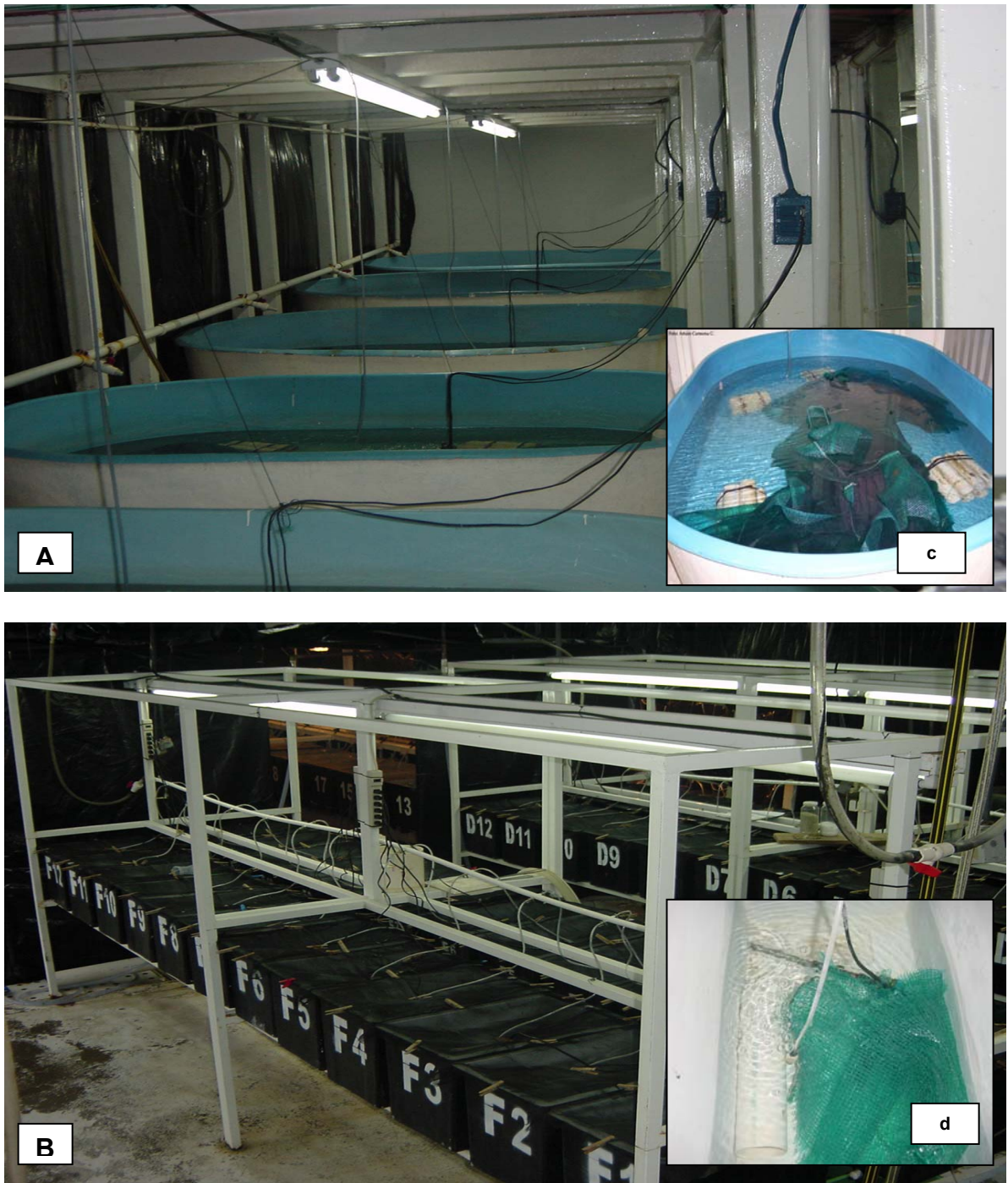
Figura 5. Sistemas utilizados para la realización de las evaluaciones experimentales. Módulo A con 24 unidades de 1500L (A). Módulo B con 48 acuarios de 80L (B). Fotografías del interior de las unidades experimental del Módulo A (c) y B (d), las cuales contenía escondrijos.
