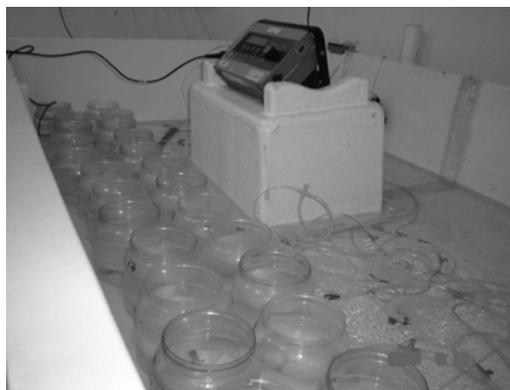
Figura 8. Sistema de respirometría utilizado para determinar el consumo de oxígeno de camarones alimentados con diferentes niveles de harina de frijol yorimón entero.
