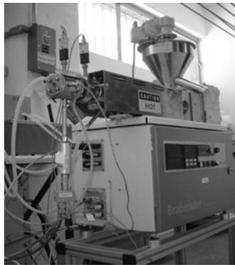
Figura 6. Extrusor de tornillo simple Marca Brabender, modelo Do-Corder usado para extruir el frijol yorimón.
