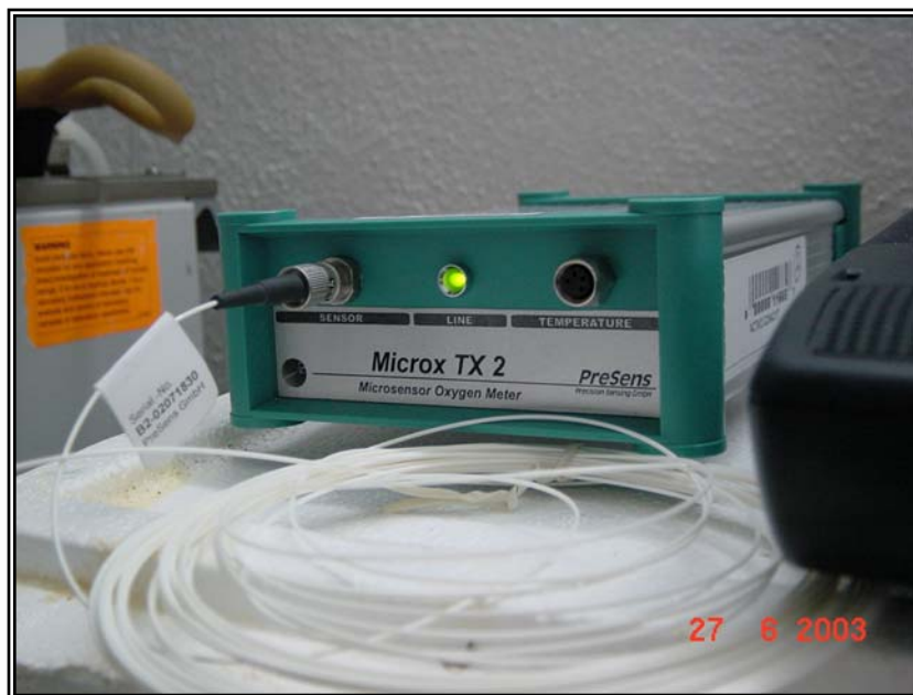
FIGURA 10. Oxímetro Microx TX utilizado para la determinación de oxígeno disuelto ( PO_2 ) en la almeja mano de león ( Nodipecten subnodosus ).
