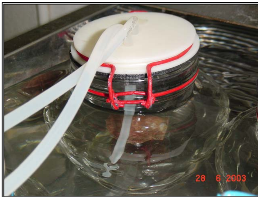
FIGURA 8. Cámara independiente con manguera de silicón a través de la cual se le suministra agua de mar a la salinidad en experimentación y a una temperatura de 22 ° C.
