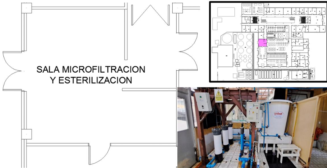
Figura 1.5.8. Sala microfiltración, desinfección con UV y ozono. Cuadro superior derecho indica la localización en el plano general. (autor C. Basulto y G. Merino).
