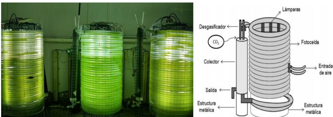
Figura 6.3.3.2.1. Fotobiorreactores tubulares helicoidales, implementados en el Parque Marino, Puntarenas-Costa Rica. Fuente: Carvajal- Oses, 2018.
