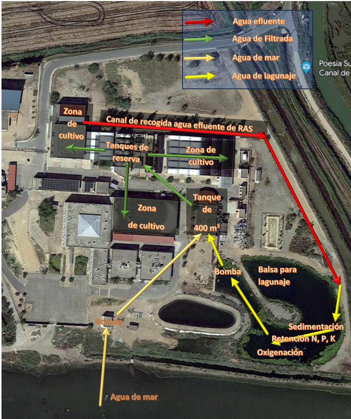
Figura 1.3.9. Esquema de la planta general y circuito hidráulico de recirculación de agua del Centro de Investigaciones.
