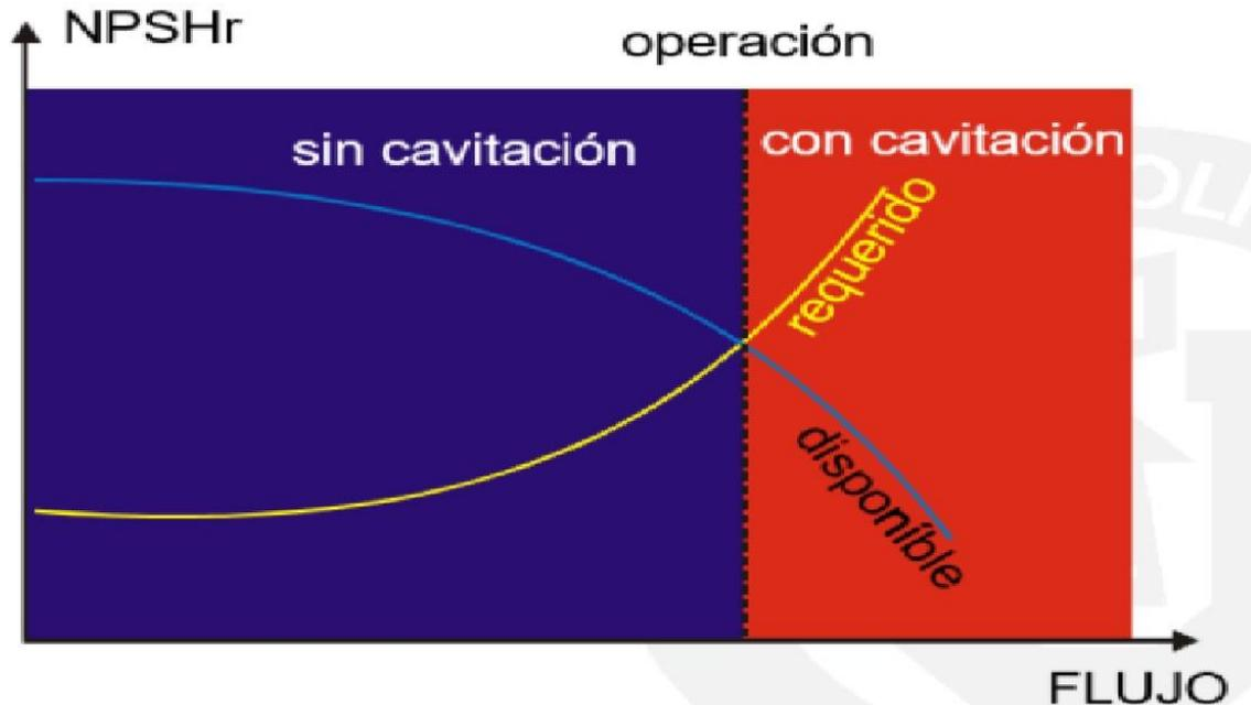
Figura 1.2.10. El  $NPSH_d$  disminuye con el incremento del flujo o caudal de agua, y por su lado  $NPSH_r$  incrementa. El diseño debe siempre cautelar que  $NPSH_d > NPSH_r$ . (autor J. Barraza)
