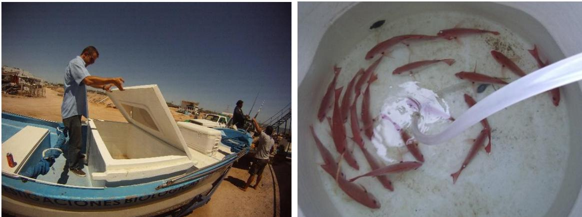
Figura 9 Vivero de  $1\text{m}^3$  para transporte de peces, del tamaño para uso en pick up o lancha (foto JC Pérez Urbiola)
