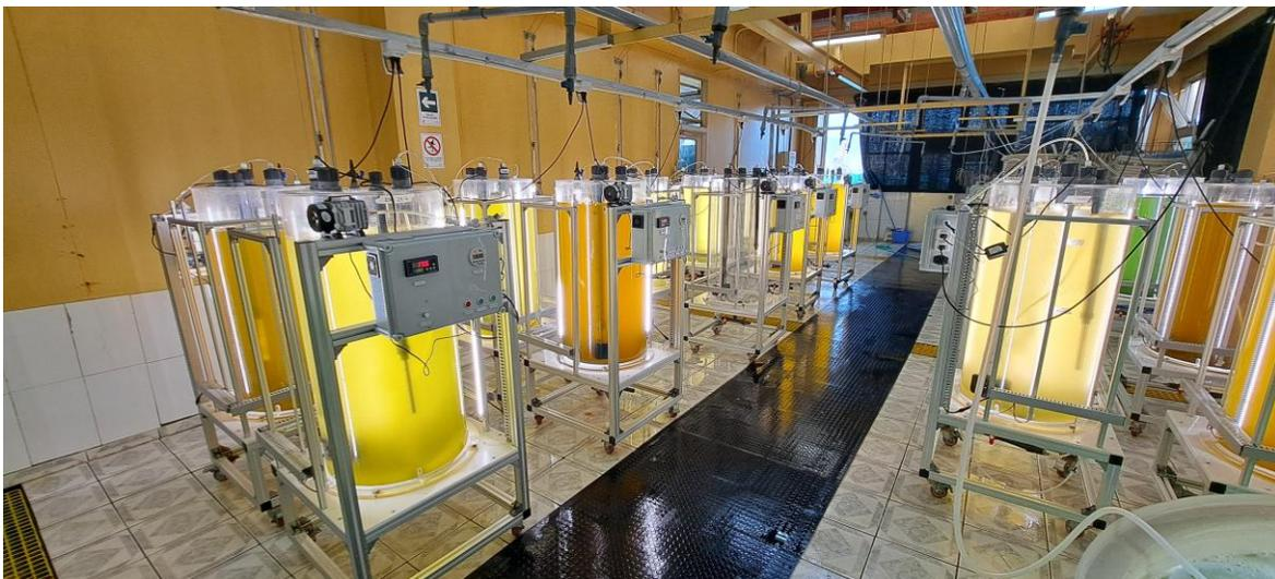
Figura 1.5.10. Sala Cultivo Masivo Microalgas. Biorreactores automatizados actualizan la tecnología de cultivo de microalgas. (autor G. Merino)
