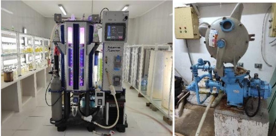
**Figura 1.6.9.** *Fotobiorreactor Plankton para la producción de microalgas, y B. Centrifuga, CENAIM-ESPOL. (autora S. Reinoso)*
