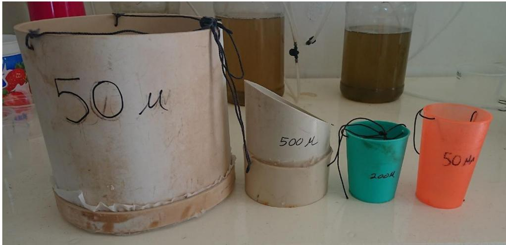
Figura 17. Diferentes tipos de tamices y tamaños de malla para selección de copépodos.
