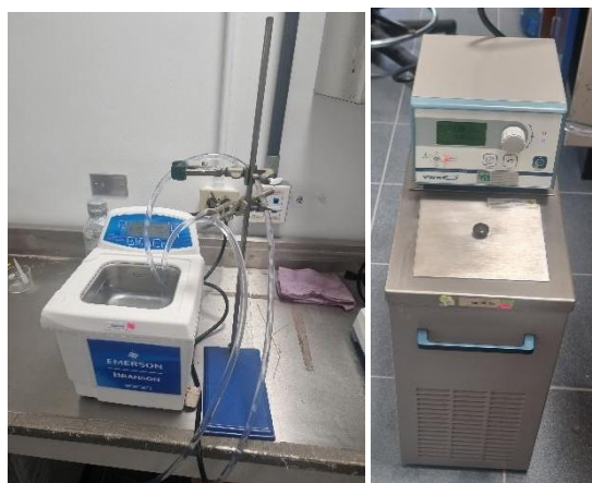
Figura 10. Arreglo experimental del sistema de recirculación para obtener el dopaje de N en las estructuras de GO.
