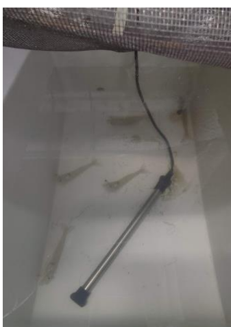
Figura 12. Unidad experimental para los bioensayos de digestibilidad, incluyendo 5 organismos, un calentador de titanio y una piedra aireadora.
