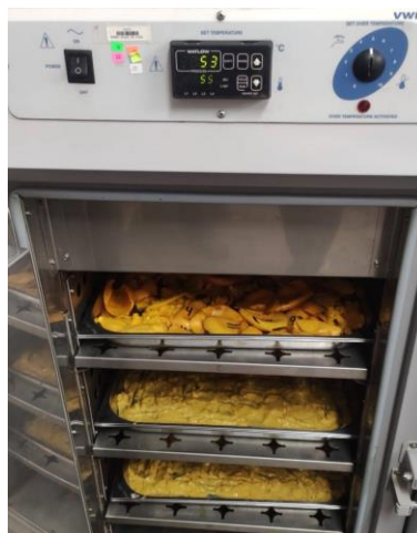
Figura 3. Prueba de secado: en la parte superior del horno VWR se colocó directamente el subproducto fresco, mientras que en las partes inferiores se observa la pasta húmeda.
