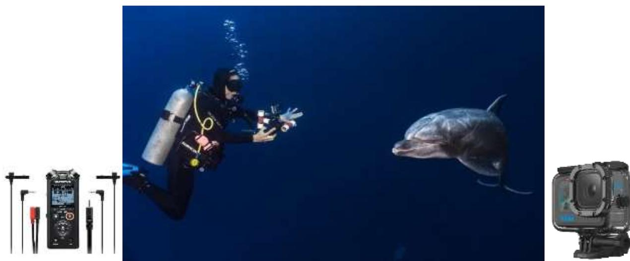
**Figura 5.** SMTB buceando y realizando la toma de datos acústicos usando el sistema sumergible de grabación acústica que consta de una grabadora TASCAM (foto izquierda) dentro de una carcasa conectada a un hidrófono, el cual también se conectó a la cámara GoPro10 (foto derecha).
