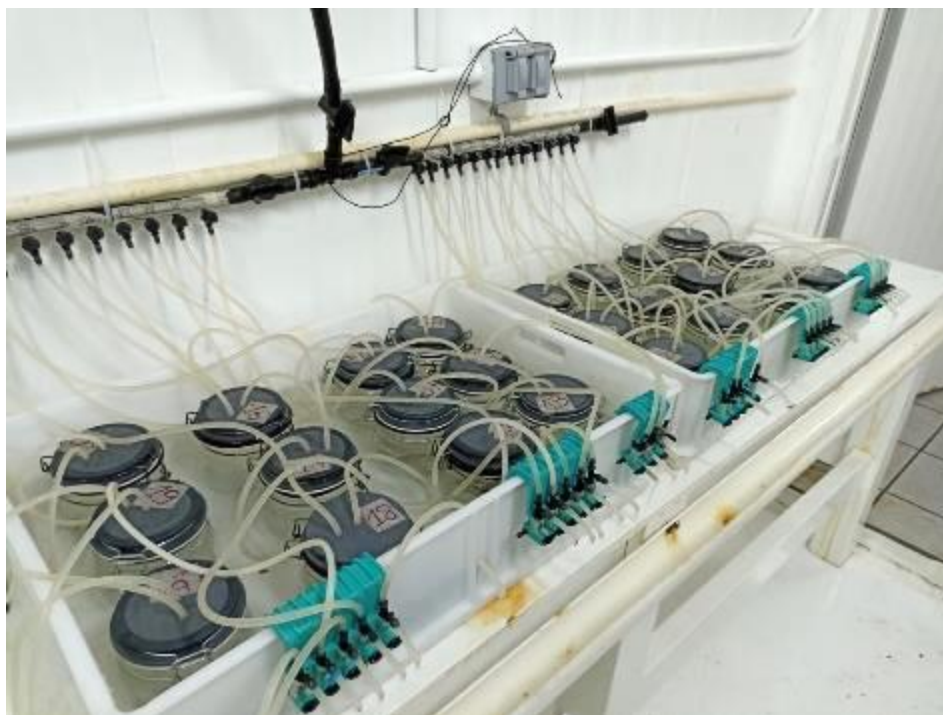
Figura 5. Sistema de cámaras de flujo continuo utilizado en el experimento 1.
