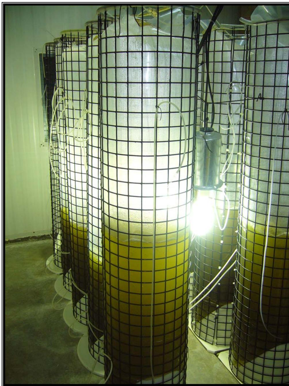
**Figura 1.** Sistema de producción continua de microalgas. Se muestra la disposición de los reactores de 200L, para aprovechar la iluminación de un solo foco de 400 Watts para cuatro reactores.
