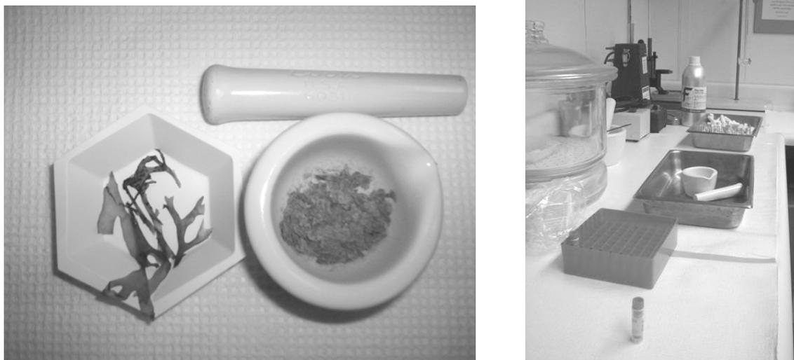
Figura 4. Material utilizado en la homogeneización de las muestras
