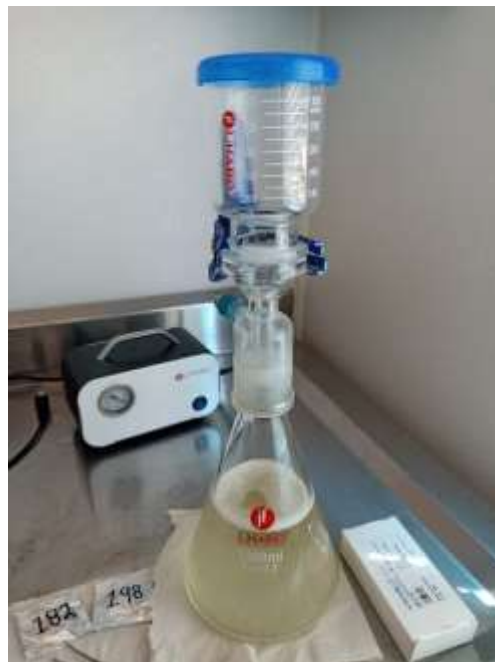
Figura 10. Proceso de filtración mediante bomba de vacío.
