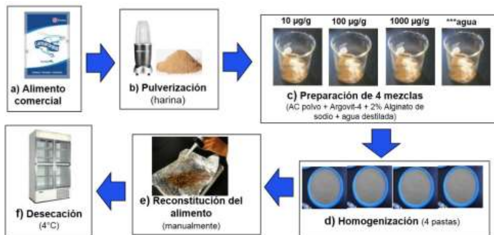
Figura 7. Proceso de adición de AgNPs al alimento para camarón.
