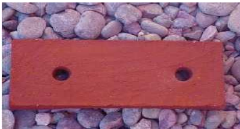
Figura 4. Loseta de ladrillo diseñada específicamente para el estudio de reclutamiento de coral y de la fauna incrustante en el área impactada y áreas testigos.
