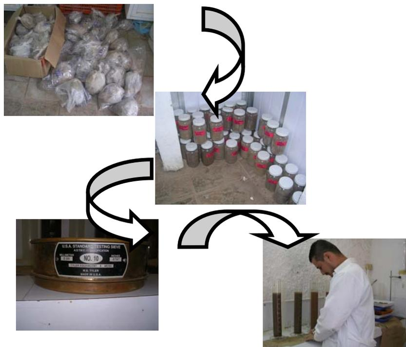
Figura 3. Diagrama de flujo para la determinación del parámetro de textura del suelo por el método de Bouyoucos (1936).
