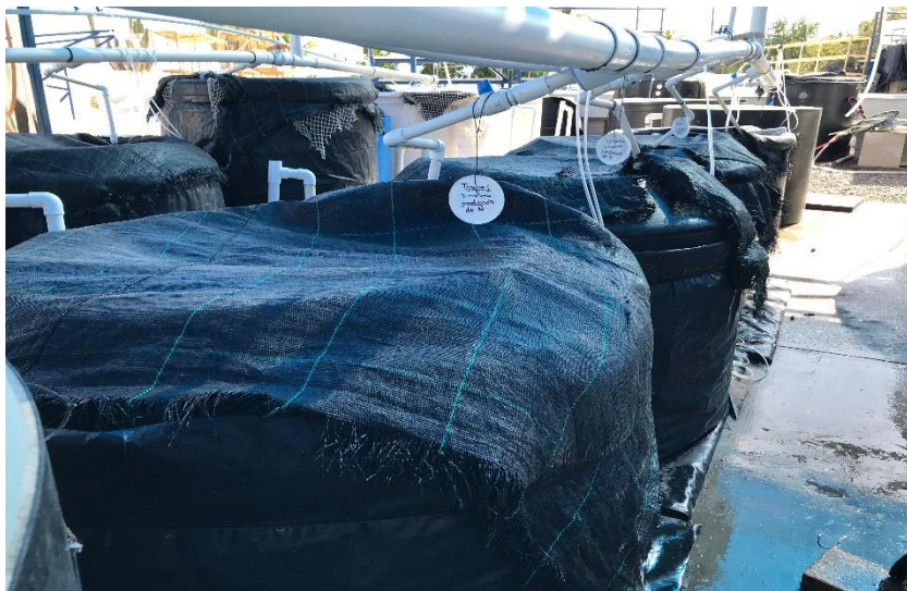
Figura 8. Fotografía de sistema acuícola cerrado acondicionado en el área de recepción de peces marinos. Se observan los tanques de cultivo de S. rivoliana con capacidad de 438 L utilizados para la determinación de la excreción de amonio.
