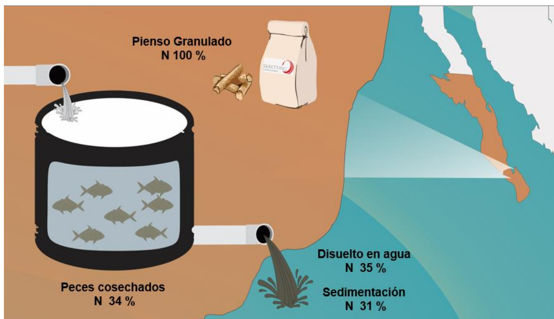
Figura 19. Esquema de balance de nitrógeno del sistema acuícola abierto con 300 % de recambio. Se define la cantidad de nitrógeno que ingresó (input) y salió (output) del sistema. De igual manera, las cantidades que fueron retenidas por los peces de cultivo Seriola rivoliana .
