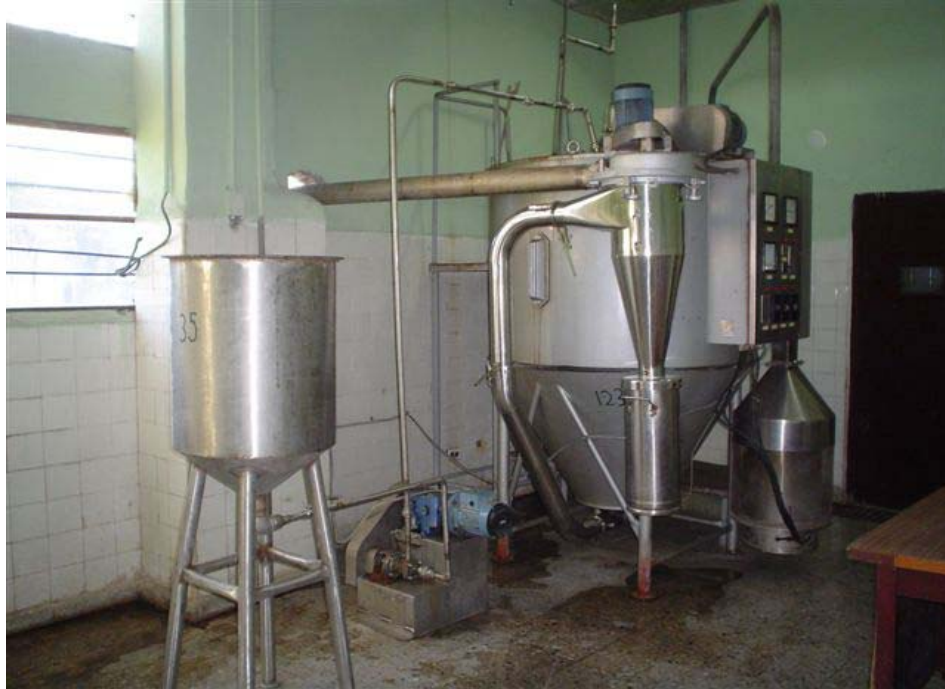
Figura 5. Equipo Niro Atomizer modelo MINOR con capacidad de secado de 5 kg/h
