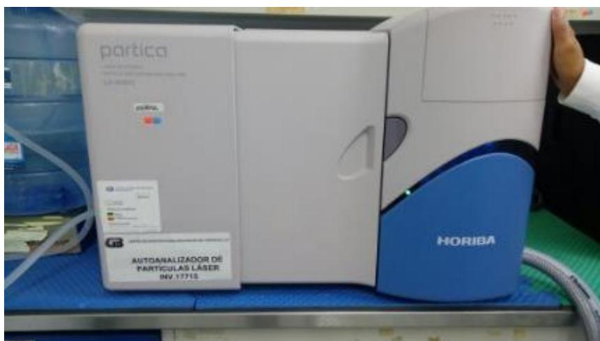
**Figura 12.** Autoanalizador láser de partículas, del Laboratorio de Edafología en el cual se realiza el análisis de textura (Fotografía: Nicole Harmelin).
