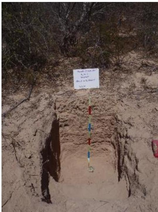
**Figura 11.** Pozo a cielo abierto en punto de verificación, para la descripción de perfil de suelo (Fotografía: Nicole Harmelin).
