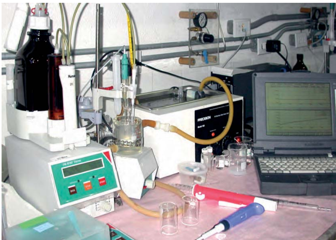
Figura 5. Equipo de pH-stat utilizado para monitorear el grado de hidrólisis de las proteínas de interés, utilizando extractos de enzimas de animales o enzimas comerciales.
