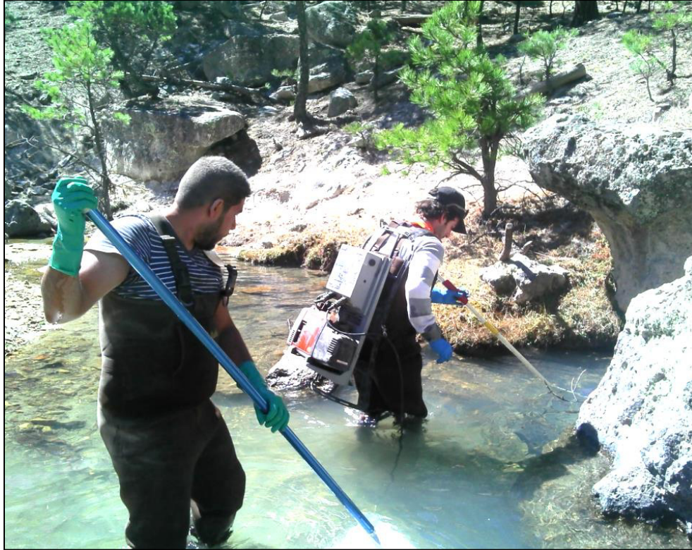
Figura. 2. Equipo de electropesca SMITH-ROOT y operación de captura de trucha dorada mexicana en arroyos de la Sierra Madre Occidental.
