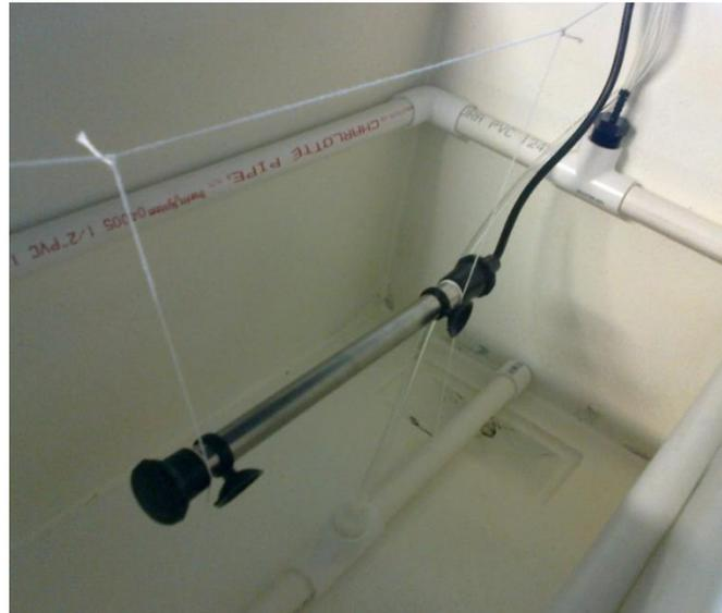
**Figura 10. Sistema de aireación de una unidad experimental.**
