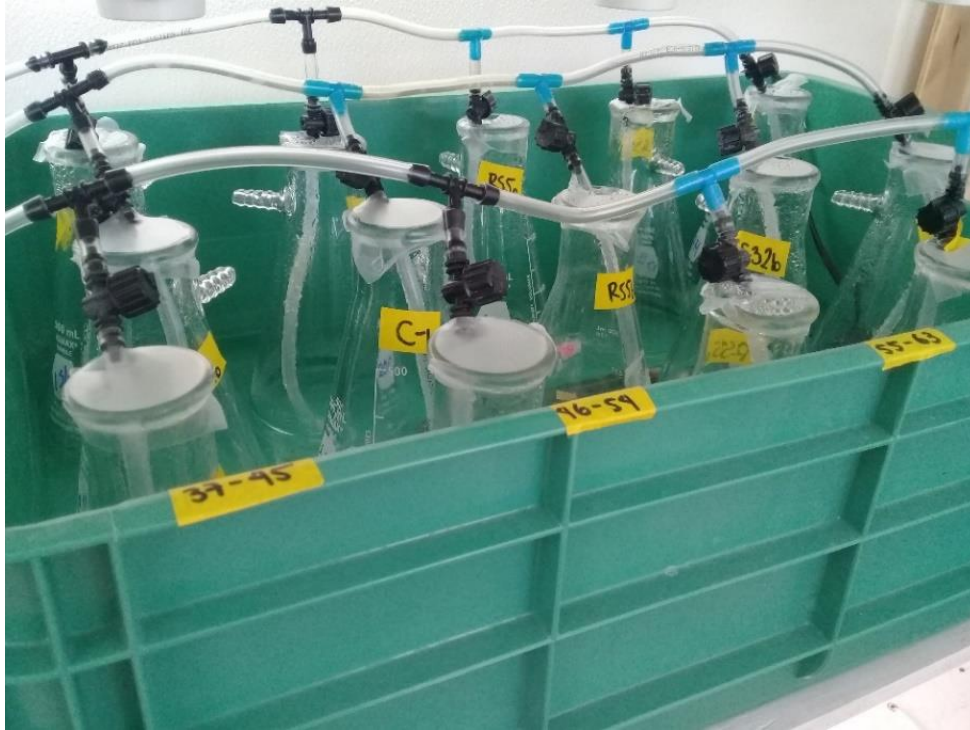
Figura 4. Unidad experimental bioensayo I. Matrices de 500 mL, aireación continua y temperatura controlada con baño María (n=3).
