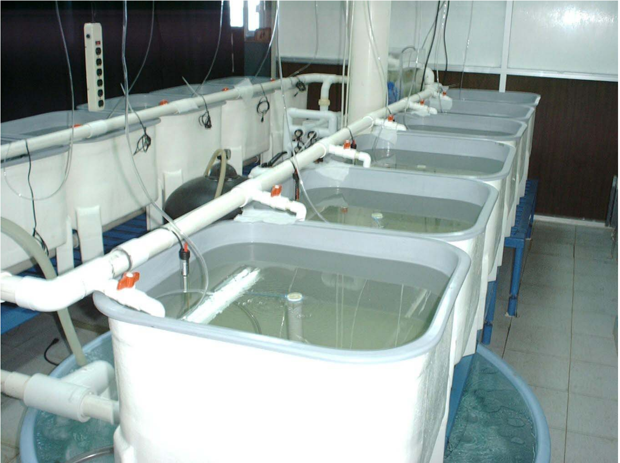
Fig. 5. Sistema experimental utilizado para el ensayo de destete y de digestibilidad en el CICIMAR. La unidad de filtración consistente de un filtro de cartucho Jacuzzi, un filtro biológico, un espumador, una unidad de luz U.V., y un termostato de titanio.
