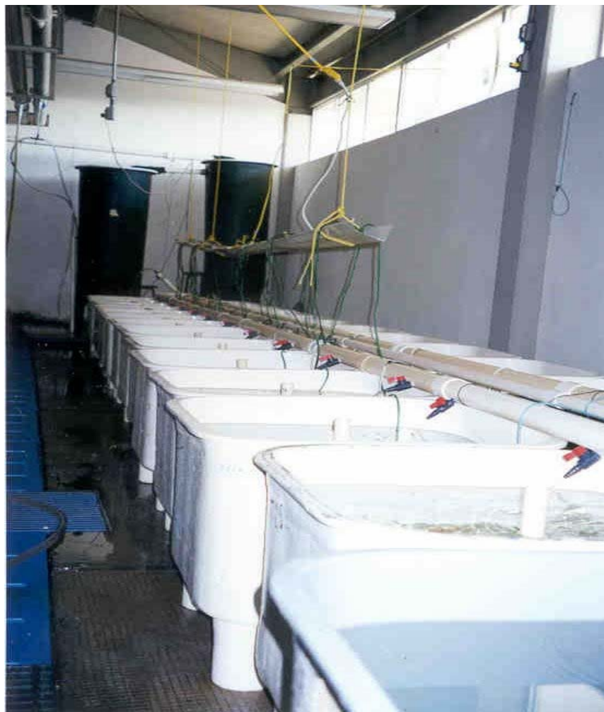
Fig. 6. Sistema experimental usado para estudiar los requerimientos de proteína y energía en Pichilingue. Los dos tanques cónicos de sedimentación se observan al fondo de la fotografía.
