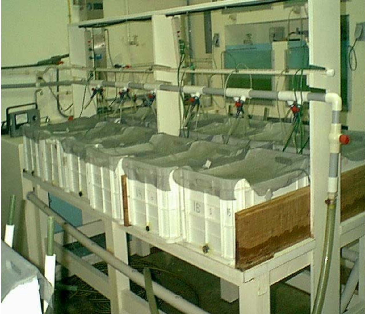
Fig. 4. Acuarios experimentales del sistema de flujo abierto de agua utilizado en el CIBNOR para el experimento del efecto de varias temperaturas y densidades.
